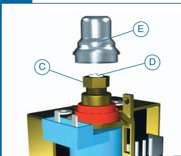
Все регулировки должны быть сделаны на базе специфических характеристик агрегата. Проверьте входное и выходное давление, используя штуцеры для измерения давления газа. После проверки, тщательно заглушите штуцера соответствующими винтами. Рекомендуемый затяжной момент: 1.0 Нм. Отсоедините трубку регулятора давления на штуцере «VENT» (если она есть). Снимите пластиковый колпачок модулятора Е.
