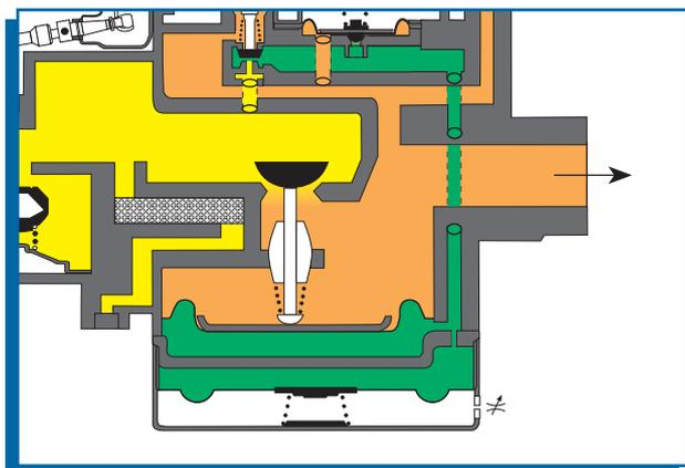
Когда катушка EV2 размыкает сеть в серво системе, газ поступает в камеру медленного открытия. Давление газа под основным клапаном мембраны устанавливается на определенном уровне и частично позволяет газу поступать в камеру.
