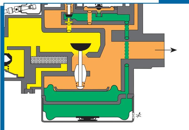
По прошествии определенного времени пружина плавного открытия полностью сжимается, поэтому объем больше не меняется, и давление под основной мембраной быстро повышается, полностью открывая основной клапан.
