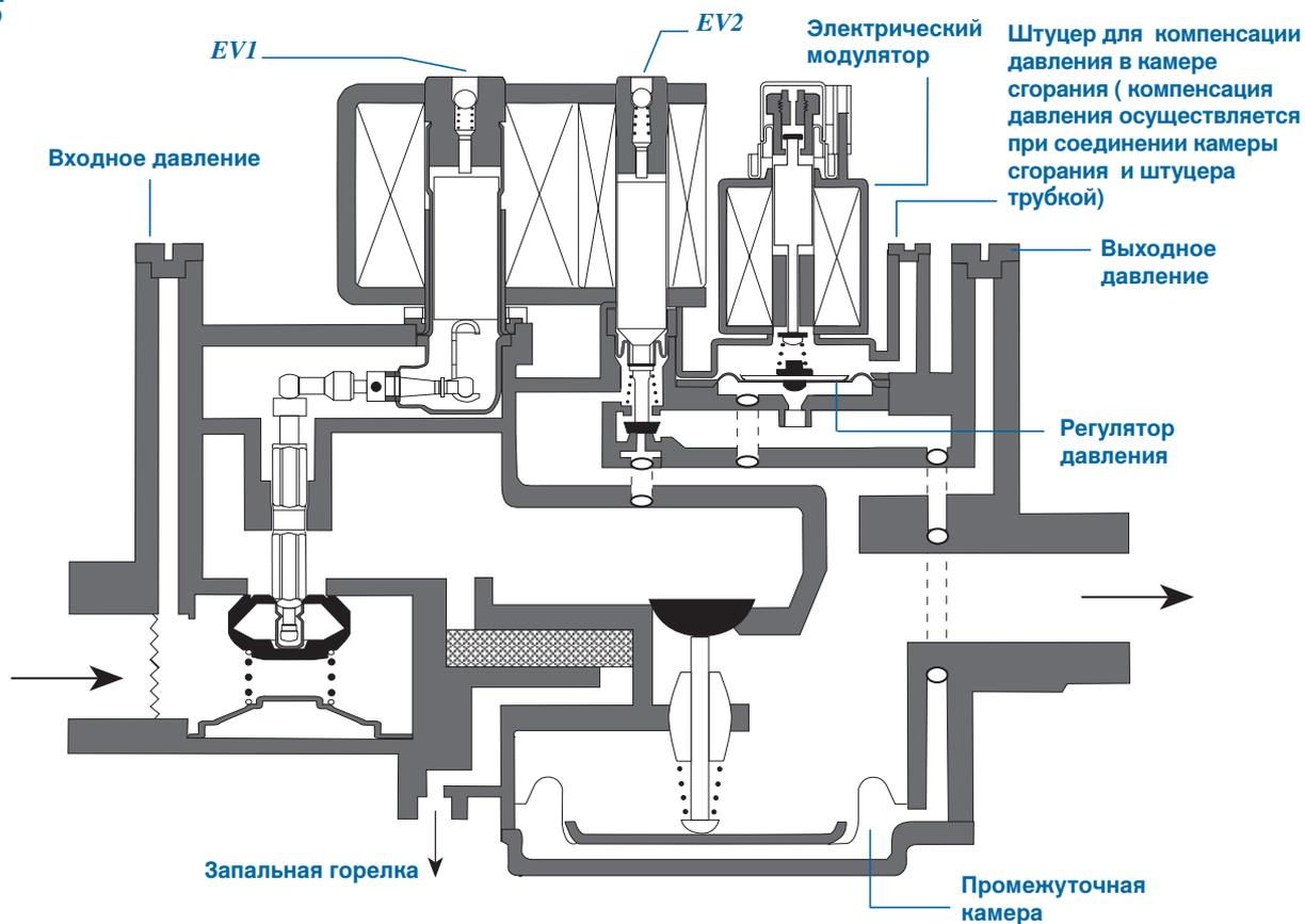
SIGMA имеет два запорных электромагнитных клапана.
